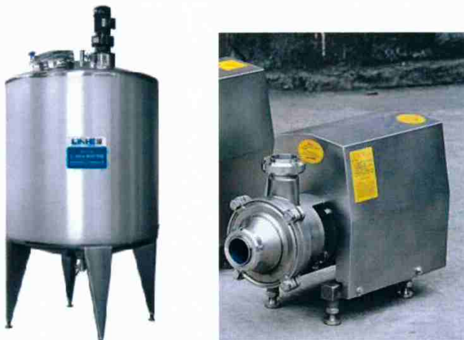
Figura 12 - Tanque misturador e bomba para transferência do material
